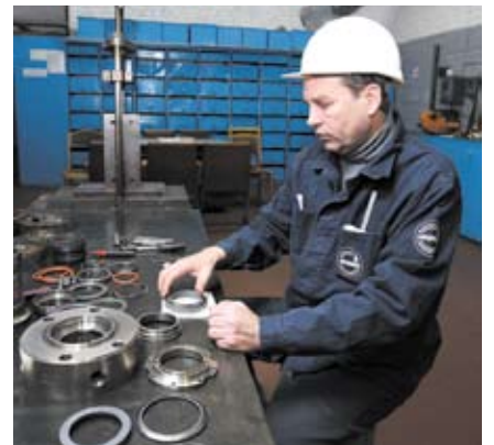
Слесарь по ремонту технологических установок, бригадир Валерий Кривицкий собирает торцевое уплотнение для насоса установки «Висбрекинг-Термокрекинг»
